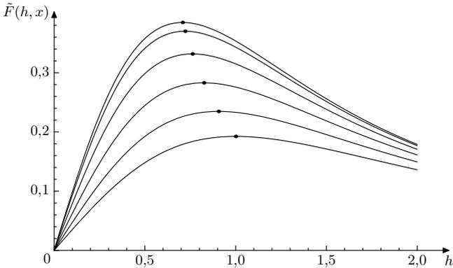
Abbildung 3 zeigt die Verläufe der Beleuchtungsstärke (als Funktion von  $h$ ) an sechs äquidistanten Punkten  $X$  auf  $AE$ , wobei  $r = 1$  gesetzt wurde und die oberste Kurve zu  $A$  ( $x = 0$ ), die unterste zur benachbarten Tischecke  $E$  ( $x = r$ ) gehört. Die jeweiligen Maxima sind markiert.
